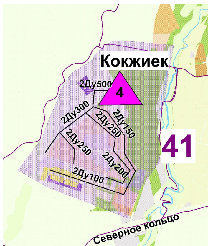
Рисунок 6.3.7.1. Карта-схема развития зоны котельной «Кокжиек» ТОО "АТКЭ" с нанесением существующих и перспективных магистральных тепловых сетей в период до 2040 г.
